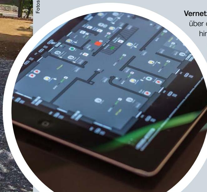
**Vernetzt** Von der Beleuchtung über die Fenster und Türen bis hin zur Photovoltaikanlage und Wärmepumpe: Die gesamte Haustechnik im Sonnenhaus Plus wird über ein Bussystem gesteuert. Das erhöht den Komfort, sorgt für mehr Sicherheit und hilft, die Energie so effizient wie möglich einzusetzen.
