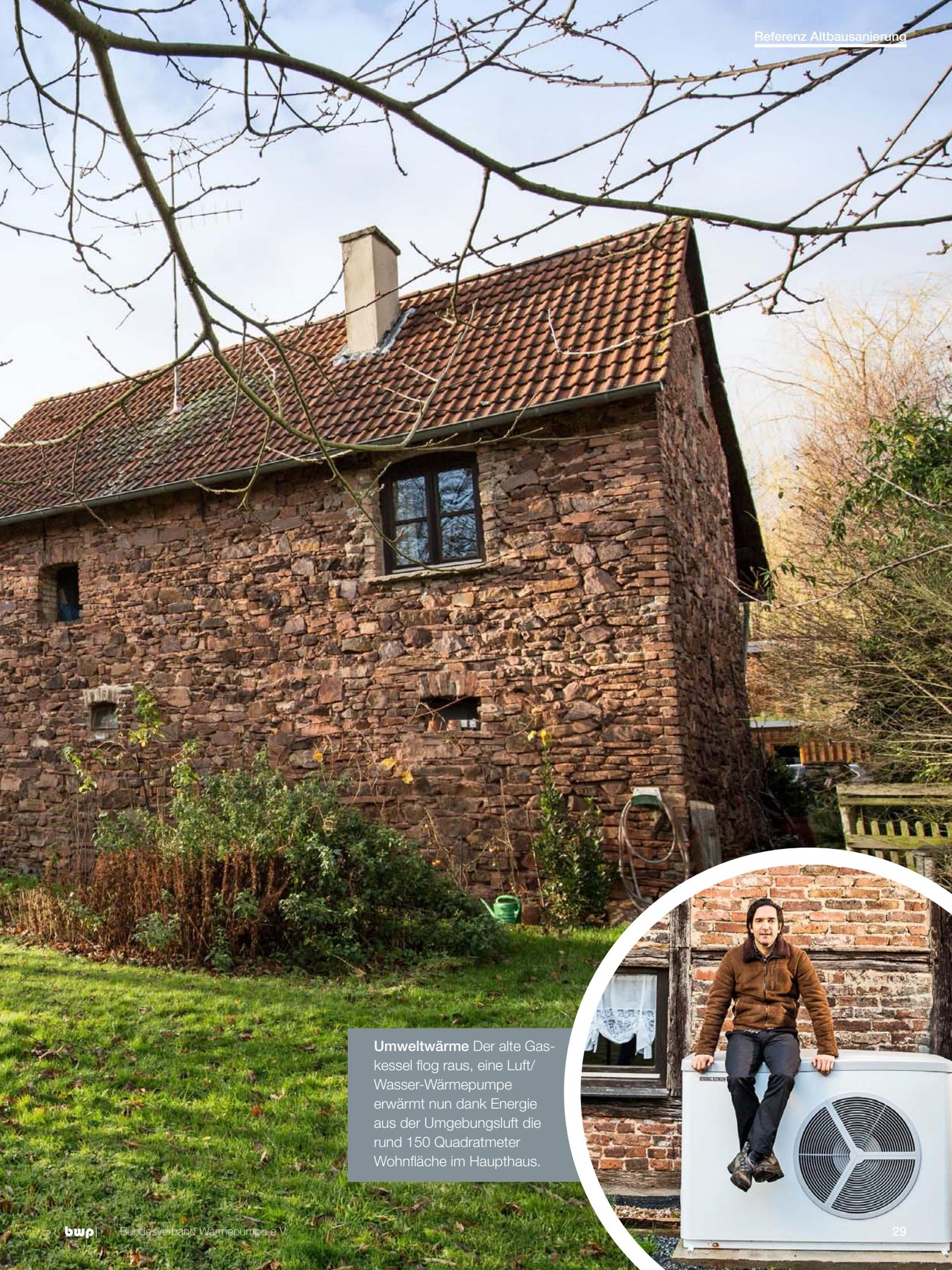
**Umweltwärme** Der alte Gaskessel flog raus, eine Luft/Wasser-Wärmepumpe erwärmt nun dank Energie aus der Umgebungsluft die rund 150 Quadratmeter Wohnfläche im Haupthaus.
