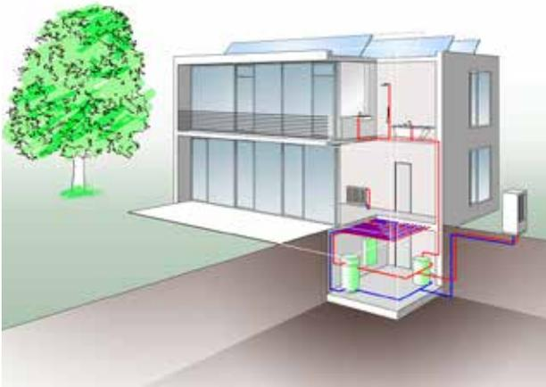
Luftwärmepumpen nutzen die Umgebungsluft zum Heizen. Im Vergleich zu anderen Wärmepumpenanlagen stechen durch geringe Investitionskosten hervor und sind insbesondere für Neubauten mit geringem Wärmebedarf gut geeignet.
