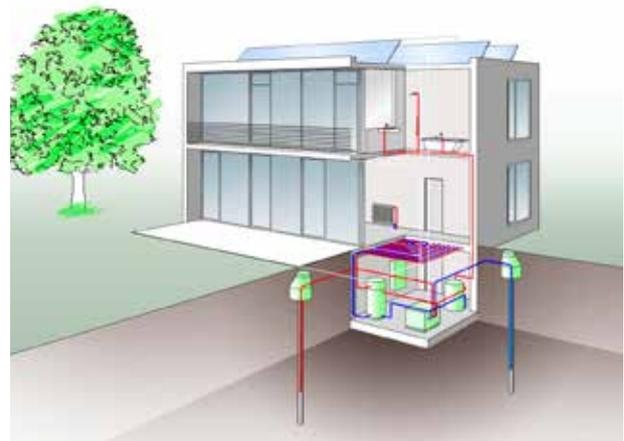
Grundwasser ist ein sehr guter Wärmespeicher mit ganzjährig relativ konstanten Temperaturen. Selbst an kalten Wintertagen besitzt das Wasser noch eine Temperatur von 7 bis 12 °C. Ist Grundwasser in ausreichender Menge und Qualität vorhanden, kann es als Wärmequelle genutzt werden. Wasser/Wasser-Wärmepumpen sind vorwiegend für größere Projekte gut geeignet, da sie einen großen Planungsaufwand erfordern.
