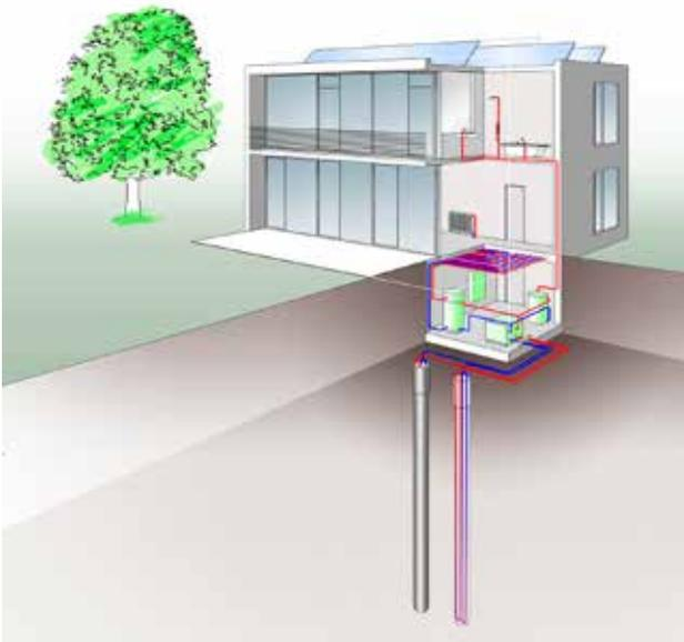
Wärmepumpen, die ihre Wärmeenergie über Erdsonden, Erdkollektoren, Erdwärmekörbe, Grabenkollektoren oder Energiepfähle beziehen, nutzen die im Erdreich gespeicherte Wärme.
