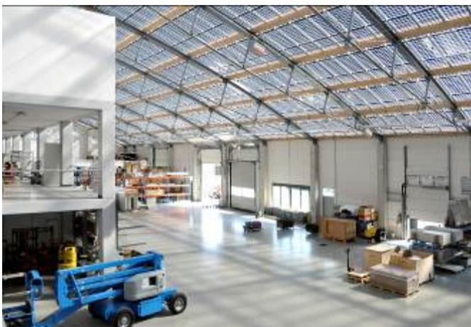
**Isocal 2:** Etwa 10% der Dachfläche sind aufgrund der transparenten Rückfolie der Module lichtdurchlässig. In vielen Bereichen kann daher in angenehm diffusem Tageslicht gearbeitet werden.
