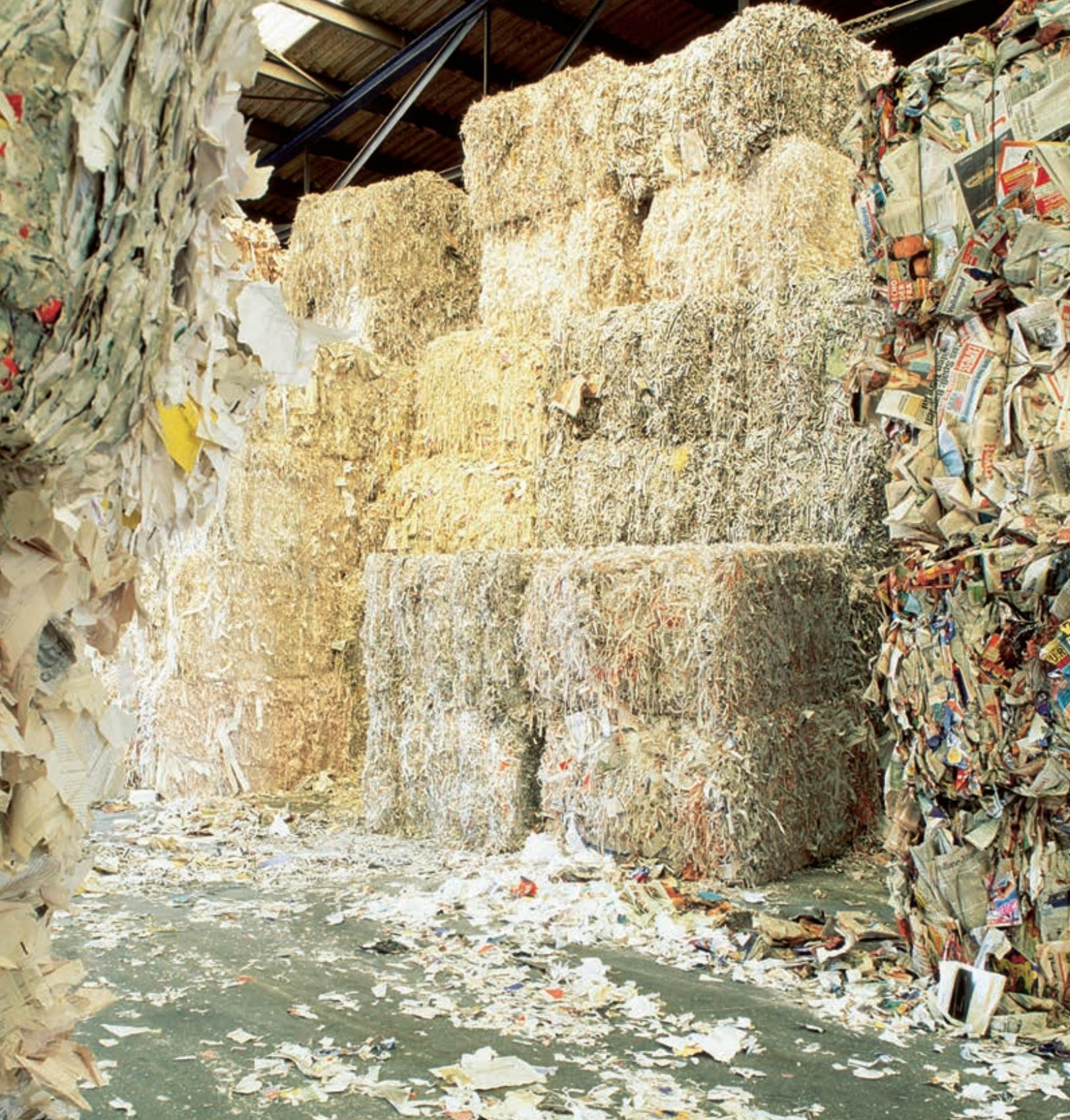
**Rohstoff Altpapier** — Rund 65 Prozent der Papier-, Karton- und Pappproduktion speisen sich mittlerweile aus Altpapier. Insgesamt wäre sogar eine Einsatzquote von 80 Prozent möglich, da dem Produktionskreislauf nur rund 20 Prozent Primärfasern zugeführt werden müssen, um Qualitätsverluste beim Recycling auszugleichen. Derzeit wird Altpapier vor allem für die Herstel-
