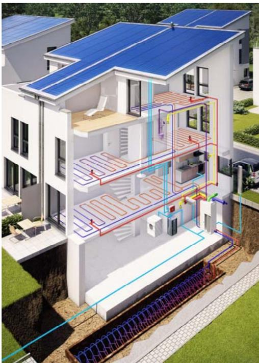
**0502\_ Plusenergiehäuser:** Jede der acht Doppelhaushälften bekommt seine eigene Erdwärmekollektoranlage, die im Winter zuverlässig für wohlige Wärme sorgen wird.
