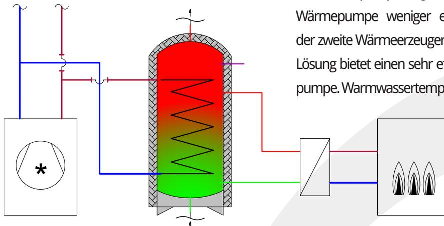
Abb.1.6: Trinkwarmwasserspeicher mit zweitem Wärmeerzeuger und externem Wärmeübertrager
