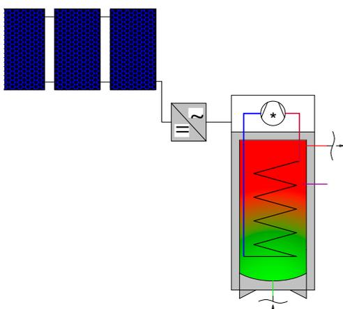
Abb. 1.3: Warmwasserwärmepumpe mit PV-Eigenstromnutzung
