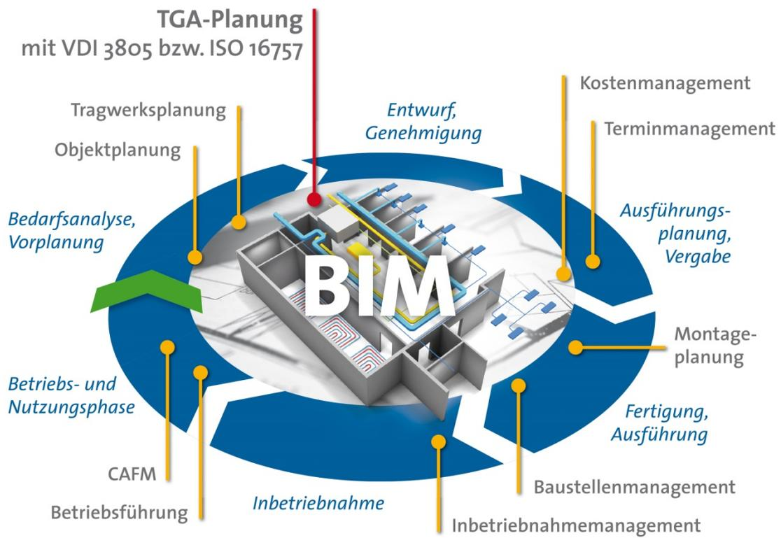
Abbildung 1: Anwendungsbeispiel für BIM (inklusive **TGA-Daten**) über den Lebenszyklus (Planung, Ausführung und Betrieb) eines Gebäudes.
