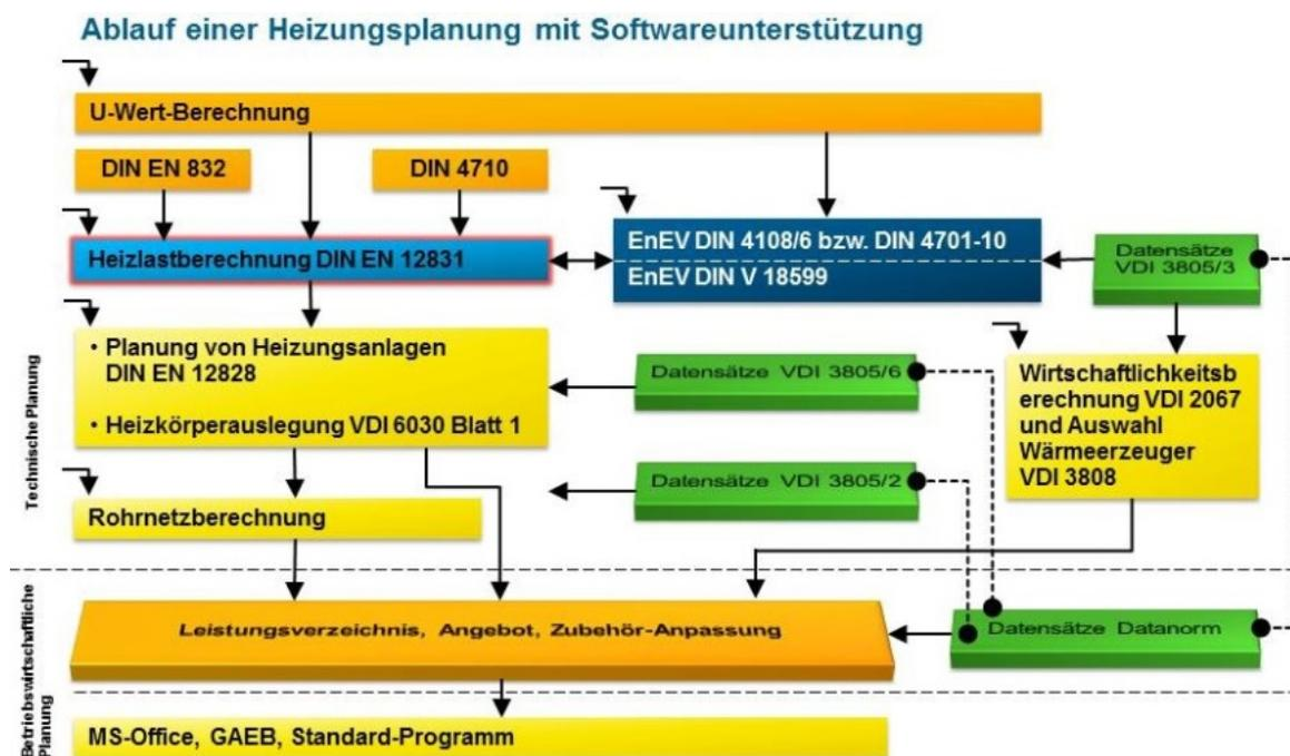
Abbildung 3: Ablauf einer Heizungsplanung mit Softwareunterstützung.
