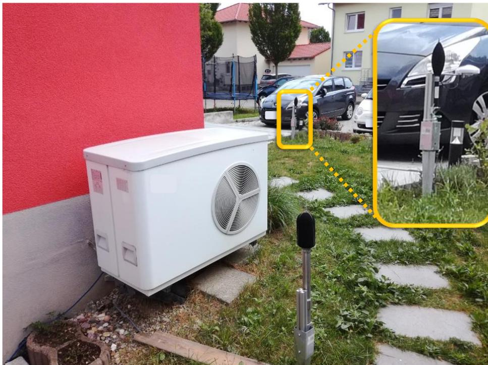
Abbildung 133: Versuchsmessung an einer Außenluft/Wasser-Wärmepumpe; im Vordergrund zu sehen ist das wärmepumpennahe Mikrofon, im Detail das zweite Mikrofon zur Erfassung der Umgebungsgeräusche
