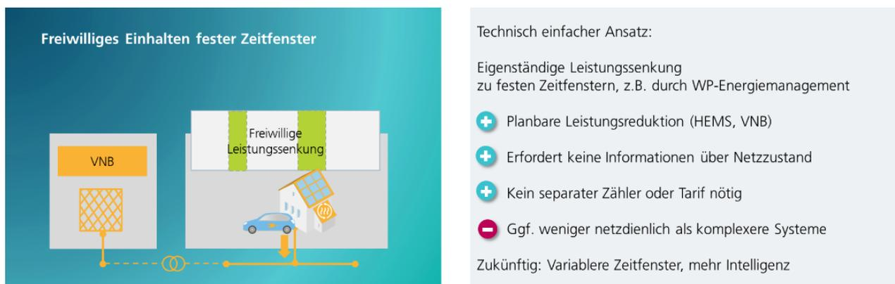
**Abb. 9:** Eine freiwillige Leistungssenkung stellt einen Ansatz dar, um mit autark umgesetzten Anlagenfahrweisen einen netzdienlichen Effekt zu erzielen.
