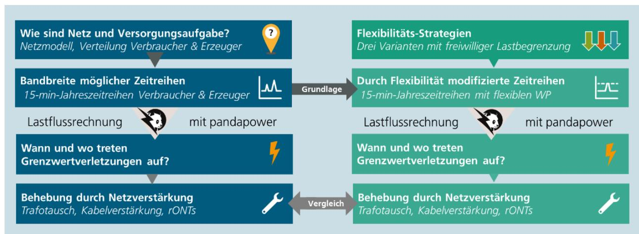
Abb. 11: Ablauf der Modellrechnung zur Ermittlung künftiger Netzbelastungen durch Zubau neuer Verbraucher.
