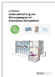
Zunehmend werden in Wärmepumpen brennbare Kältemittel eingesetzt. Normative Vorgaben existieren für die Innenaufstellung von Wärmepumpen, die solche Kältemittel einsetzen. Dieser Leitfaden soll als Hilfestellung für den Umgang mit außen aufgestellten Wärmepumpen dienen, für die es keine offiziellen Vorgaben gibt.
